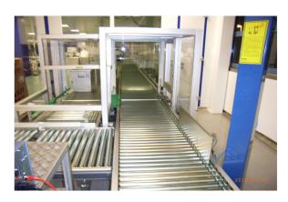
Cleanpacks werden direkt zur Palettierung gefördert, Alutrays hingegen werden von einem Pusher auf den Umpackplatz geschoben. Hier wird der Inhalt unter Einsatz einer Hebehilfe von einem Mitarbeiter in Kartons umgefüllt, die dann ebenfalls zur Palettierung gefördert werden.
