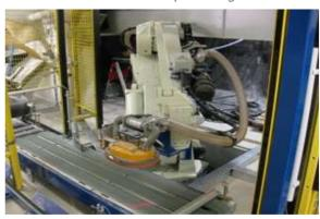
Der gefüllte Sack wird anschließend vom Stutzen geschoben, verschließt dabei automatisch und fällt auf ein bereits vorhandenes Bügelband, das sich unter dem Stutzen befindet. Das Band transportiert ihn unter einer Walze hindurch, die ihn "bügelt", so dass sich das Mehl gleichmäßiger verteilt. Anschließend wird er auf die Abnahmeposition befördert.
