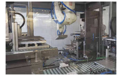
Etiketten exakt und an verschiedenen Stellen auf Behälter aufkleben oder einlegen – auch diese Aufgabe lässt sich effizient mit einem Roboter automatisieren
