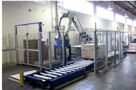
Die Zuführung der Leerpaletten erfolgt auf zwei Arten. Werden für den Palettierauftrag EURO- oder H1-Paletten benötigt, so werden diese manuell als Stapel in der Zelle bereitgestellt. Der Roboter entnimmt die oberste Palette und legt sie sich auf dem Palettierplatz bereit. Anschließend nimmt er je nach Auftrag eine Zwischenlage aus Pappe oder eine Spanplatte und legt sie auf die Palette. Diese Zwischenlagen werden ebenfalls manuell und geordnet auf einer Palette bereitgestellt.
