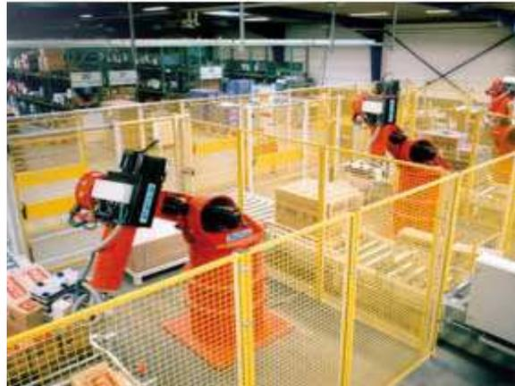
und Rückseite mit einem Etikettendrucker/Spender beklebt. Über einen zweiten Querverschiebewagen gelangt die Palette auf eine der vier Staurollenbahnen. Dort werden die Paletten per LKW zum Hochregallager gebracht.
