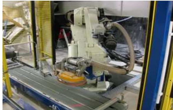
Der gefüllte Sack wird anschließend vom Stutzen geschoben, verschließt dabei automatisch und fällt auf ein bereits vorhandenes Bügelband, das sich unter dem Stutzen befindet. Das Band transportiert ihn unter einer Walze hindurch, die ihn „bügelt“, so dass sich das Mehl gleichmäßiger verteilt. Anschließend wird er auf die Abnahmeposition befördert.
